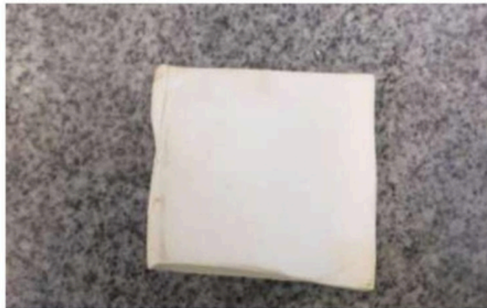
Foto 3. PU 20 após 5000 horas de exposição ao intemperismo.
